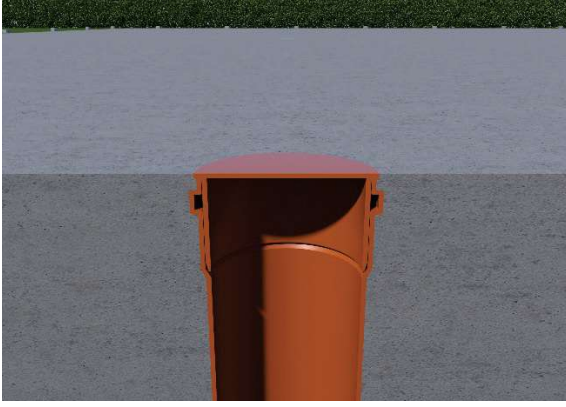
Şekil 4: Döşeme ile aynı hizada monte edilmiş boru manşonu
